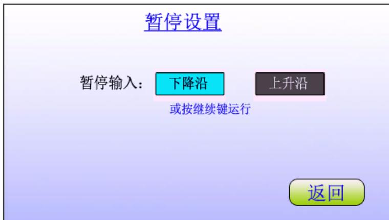
通过暂停模块可以使泵在运行过程中暂时停止运行。可以通过给泵输入外部触发信号，或者手动按运行界面出现的“继续”按钮，来结束暂停状态，继续执行方法中的后续步骤。
