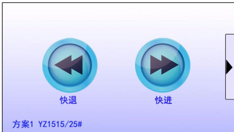
可以快速完成工作前的填充准备工作。第一次点击“快进”或“快退”按钮泵全速运行，再次点击泵停止。快进：泵顺时针方向全速运行。快退：泵逆时针方向全速运行。点击“
