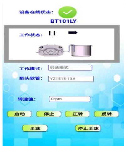
3. 进入到设备实时运行界面后，首先看设备在线状态，如果显示**绿色箭头说明设备在线**，可以操控设备，并且可以看到设备当前状态，如果**显示不在线说明设备断网了或者设备电源没有打开**，确保设备连接上网络后，方可正常使用；
