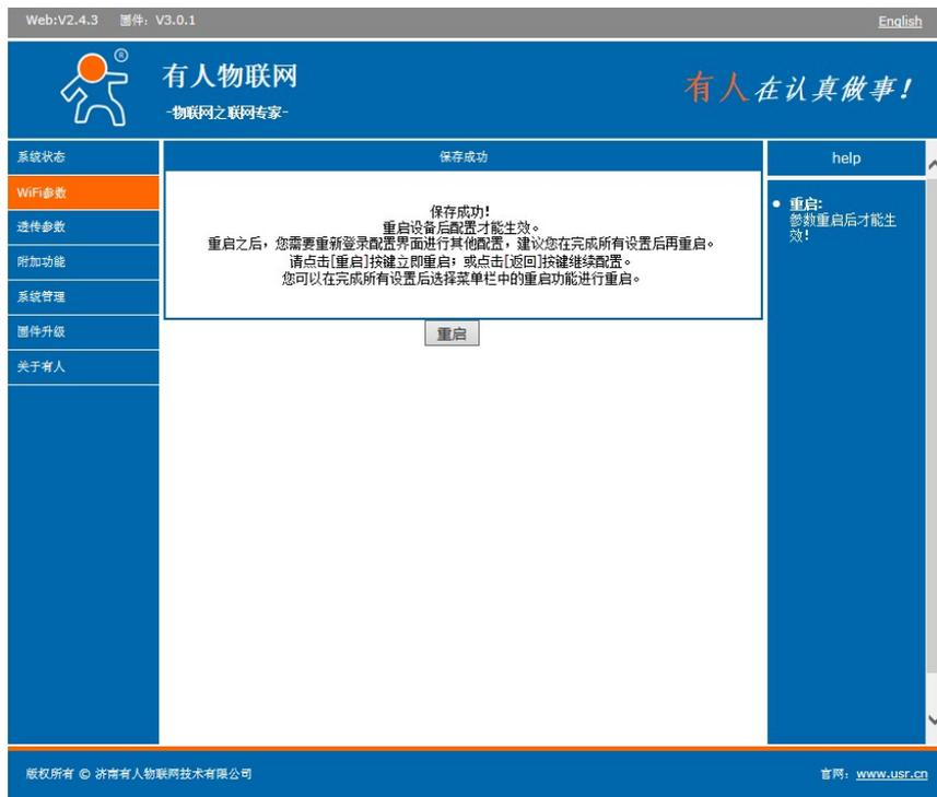
(2) 在此界面点击“重启”等待模块重启成功，如果联网正常，模块重启完成，模块的上的蓝色指示灯会常亮，说明联网成功，如果等待超过 5 分钟没亮，继续重复步骤 2，进入页面检查“STA 参数设置”处的 WIFI 名称密码以及静态 IP 分配是否正确； (3) 模块上的黑色按钮为恢复出厂指示灯，请勿随意按下；
